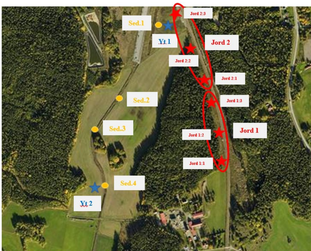
Figur 9. Ungefärliga lägen för miljöprovtagningspunkter. Blå stjärnor visar provtagningspunkt för ytvatten (Yt 1 och Yt 2), gul cirkel visar provtagningspunkt för sedimentprov (Sed.1 – Sed.4) och röd stjärna visar provtagning av jord, där stickprov slagits samman till samlingsprov (Jord 1 och Jord 2).
